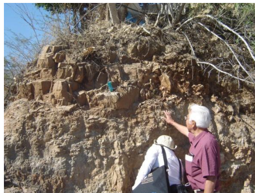
Foto 5. Clasificando la formación natural y haciendo estimación de campo de la resistencia al esfuerzo cortante.
