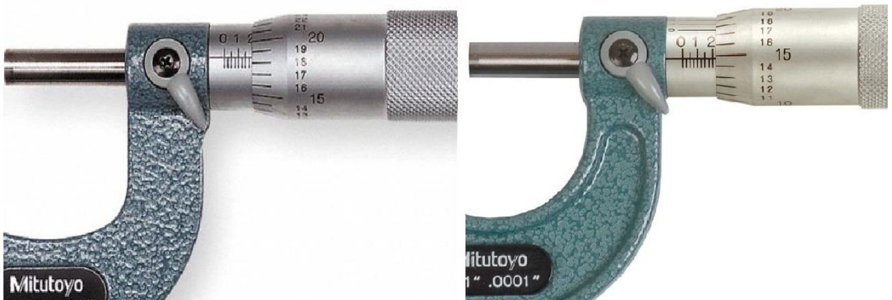
Figura 6. Micrómetro en pulgadas con resolución de 0.001 y 0.0001 in
