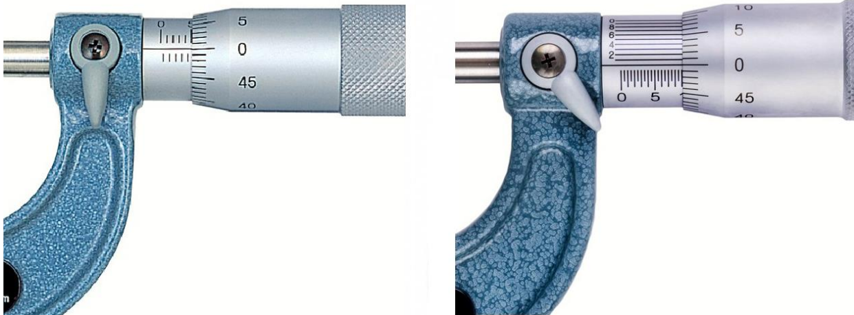
Figura 5. Micrómetro en milímetros con resolución de 0.01 y 0.001 mm
