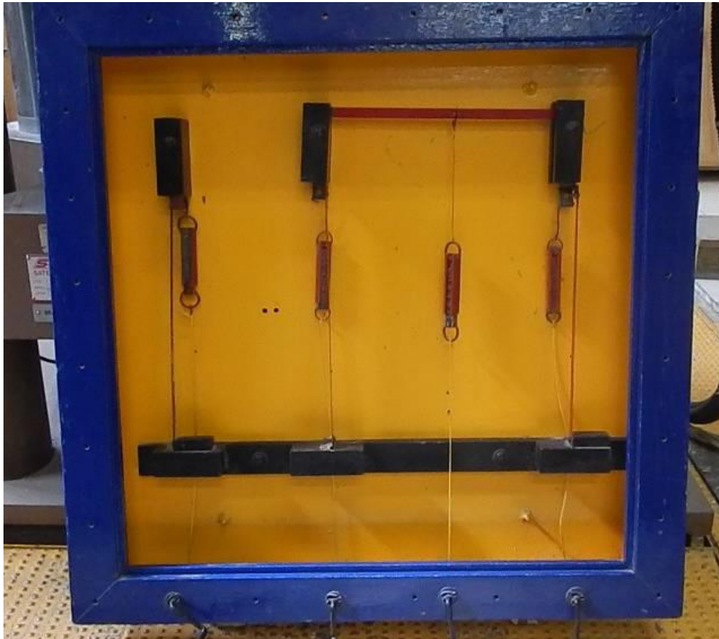
Fig. 4.10 Modelo de seguetas con distintas condiciones de apoyo en los extremos.
