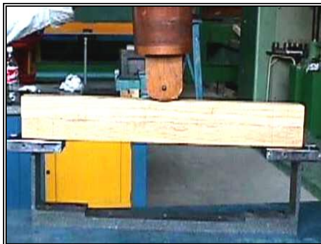
Fig. 3.6. Dispositivo para prueba de flexión en madera.
