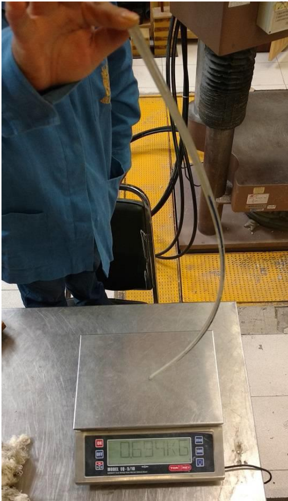
Fig. 4.11 a) Pandeo simple, n = 1 , carga en báscula \approx 0.7 kg
