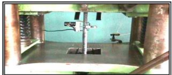
Fig. 1.7 Montaje de un cilindro estándar de concreto simple instrumentado para prueba de flexocompresión.
