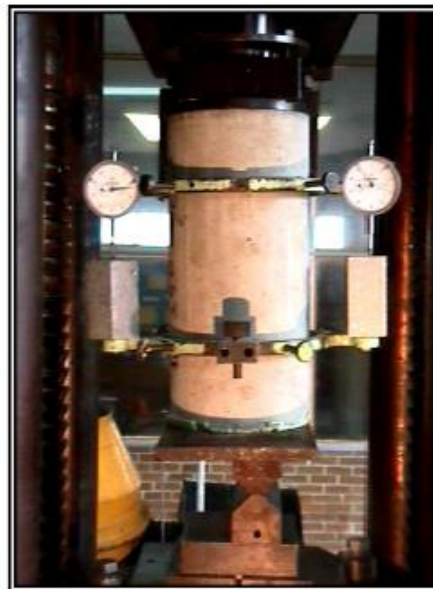
Fig. 1.7 Montaje de un cilindro estándar de concreto simple instrumentado para prueba de flexocompresión.
