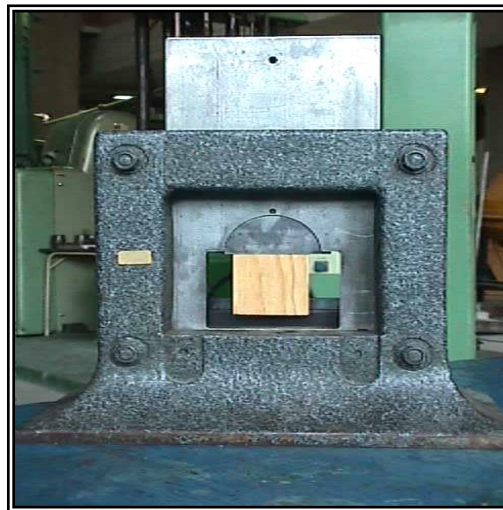
Fig.3.7. Dispositivo que sirve para ensayar las probetas de madera en cortante directo (diseñado por la A.S.T.M.)
