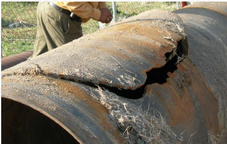
**FIGURA 5.3** FALLA EN UN CONDUCTO DEBIDA A LA SOBREPRESIÓN
