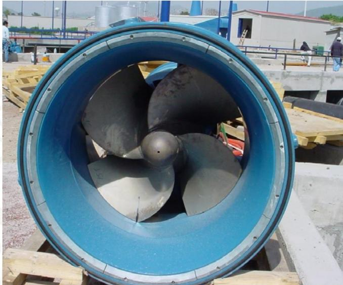
**FIGURA 2.13** IMPULSOR DE FLUJO AXIAL
