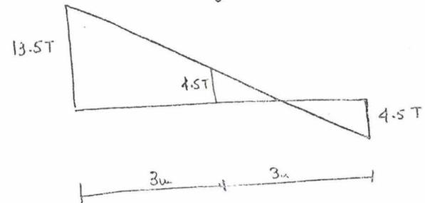
El esfuerzo máximo  $V = 13.5 \text{ Ton} = 13500 \text{ Kg}$
