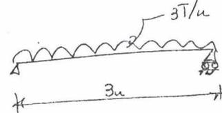
Por simetría de la viga  $R_A = R_B = \frac{3(3)}{2} = 4.5 \text{ Ton} \uparrow$
