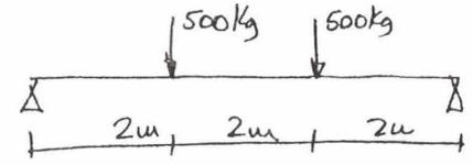
2.- Obtenga el valor máximo que alcanza el esfuerzo cortante en la viga, así como la distribución de esfuerzos cortantes en esa misma sección
