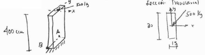
1-- Determine los esfuerzos normales y tangenciales al plano que toma  $30^\circ$  con la vertical, según se muestra en la figura encontrando también el constante máximo en cualquier plano de la pieza.
