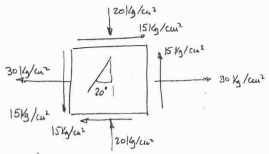
Obtenga para el estado de esfuerzos en el elemento mostrado en la figura, los esfuerzos principales y la orientación de los planos principales.
