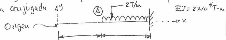
Como en el problema anterior las condiciones de apoyo se cambian del empotramiento se convierte en un extremo libre y el extremo libre se empotra. El diagrama de momentos flexionantes dividido entre  $EI$  con que se debe cargar la viga conjugada es de la viga original.
