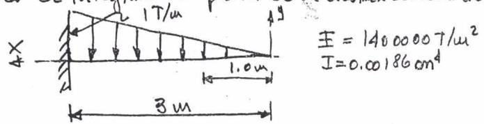
1.- Encuentre el valor de la flecha máxima y la rotación en los extremos de la viga que se muestra en la figura (utilice los teoremas de Mohr)
