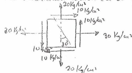
Determine el estado de esfuerzos del elemento mostrado en la figura siguiente, si la orientación cambia  $20^\circ$
