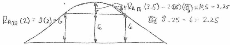
Dividiendo el diagrama de momentos flexionantes de cada viga entre  $EI$  se obtiene el diagrama de curvatura de la viga. Aplicando para los diagramas de curvatura los teoremas de Mohr. Para encontrar el giro en el extremo de la viga (A, o B) se debe tener en cuenta que
