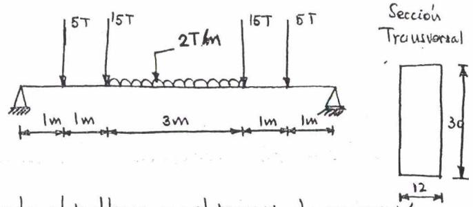
Descomponiendo el problema por el principio de superposición en los tres problemas siguientes y aplicando los teoremas de Mohr.
