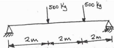
Para determinar la separación de clavos para que el juego de tableros actúe como unidad, deberá calcularse el flujo de cortante existente entre los tableros.
