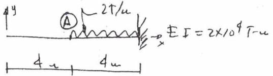
7.- Para la viga mostrada en la figura determine la pendiente y flecha en  $x=1.0m$  usando el método de integración a partir de la ecuación de la elástica
