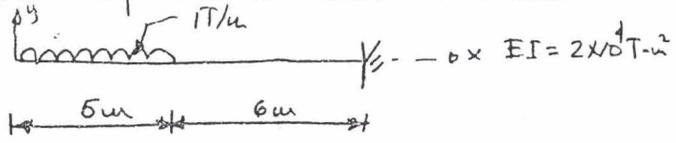
5.- Determine la flecha y la pendiente en el extremo A de la viga utilizando viga conjugada.
