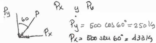
La flexion alrededor del eje x la produce  $P_y = 250 \text{ kg}$  el momento de inercia alrededor de x es  $I_x = \frac{15 \times 30^3}{12} = 33750$
