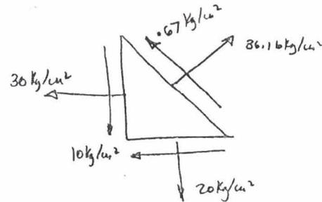
Problema 4.- Determine el estado de esfuerzos del elemento mostrado en la figura siguiente, si la orientación cambia  $20^\circ$ .
