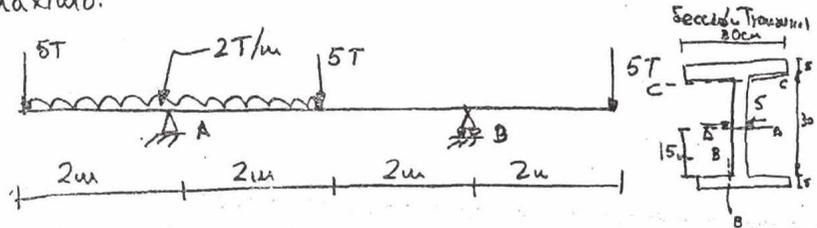
Para determinar los esfuerzos pedidos en la sección de cortante máximo, es necesario determinar los valores de las reacciones  $R_A$  y  $R_B$  de la viga para trazar el diagrama de fuerza cortante de la viga y determinar el valor del cortante máximo en la misma.
