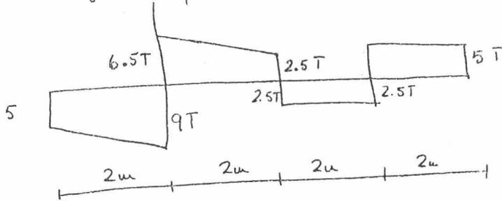
El cortante máximo de la viga es  $V_{max} = 9T = 9000 \text{ kg}$
