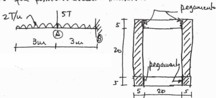
6.- Determine el valor máximo de altura el esfuerzo cortante en la viga, así como la distribución de esfuerzos cortantes en esa misma sección.
