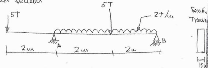
Se deben encontrar primeramente las reacciones  $R_A$  y  $R_B$  de la viga para poder hacer el diagrama de fuerza cortante de la viga y localizar en este el lugar de máximo cortante, para valor en este lugar el esfuerzo cortante máximo en la sección transversal y la distribución de esfuerzos cortantes a lo largo de la sección transversal.
