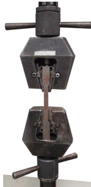
b) *Probeta plana*
