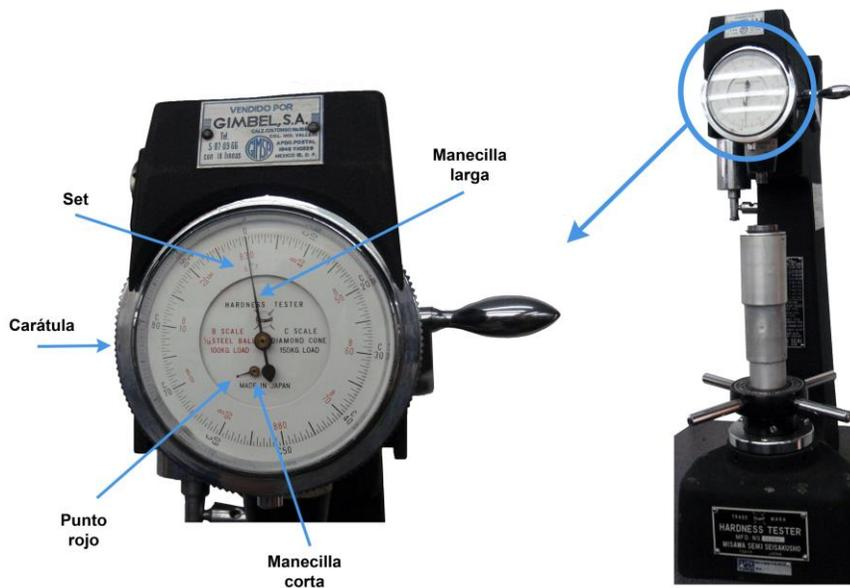
Figura 10. Detalle de la carátula del equipo Rockwell analógico.
