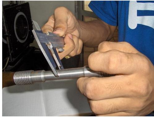
Figura 13. Medir probeta
