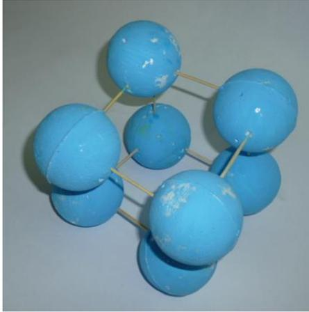
Figura 6. Estructura Cúbica Simple.
