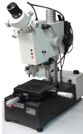
Figura 5. Equipo para ensayo de microdureza Vickers
