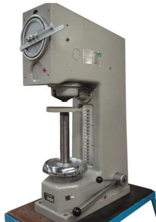
*Figura 1. Equipo para ensayo de dureza Brinell*
