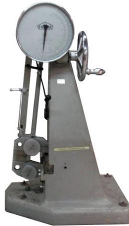
*Figura 1. Equipo para ensayo de impacto*
