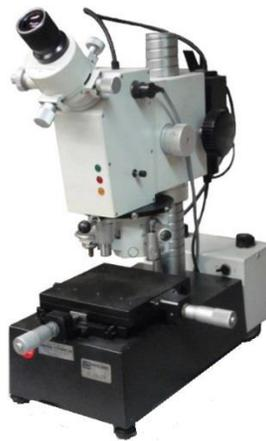
**Figura 2.10.** Equipo para ensayo de microdureza Vickers.
