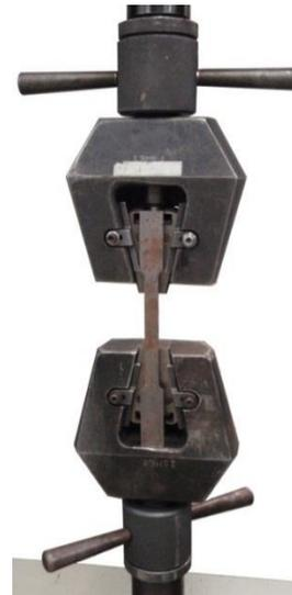
b) *Probeta plana*
