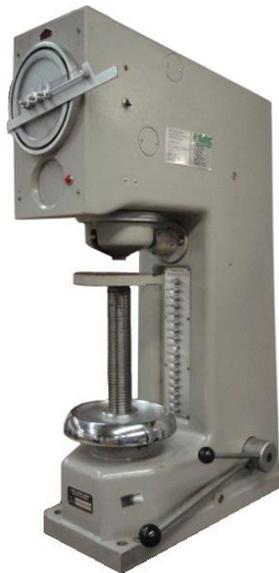
**Figura 2.2.** Equipo para ensayo de dureza Brinell
