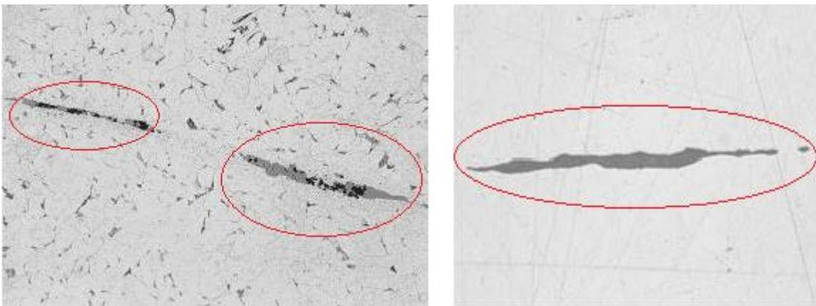
**Figura 3.8.** Imagen a 100x de una inclusión de un sulfuro. Este tipo de inclusiones sólo es posible visualizarla en un corte longitudinal, en una transversal se vería con una geometría redonda, y se caracteriza por tener bordes más suaves y redondeados. Al atacar con nital también se observa que posee una tonalidad gris claro.
