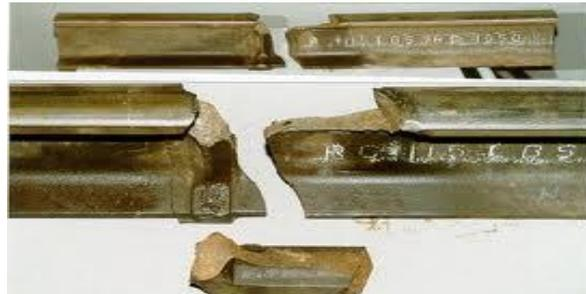
**Figura 2.20.** Ejemplos de fallas catastróficas por fracturas frágiles: izquierda, barcos soldados y tanques hechos de acero de medio C, afectados por las bajas temperaturas durante la Segunda Guerra Mundial; derecha, Rieles de trenes durante largos períodos de invierno muy fríos.
