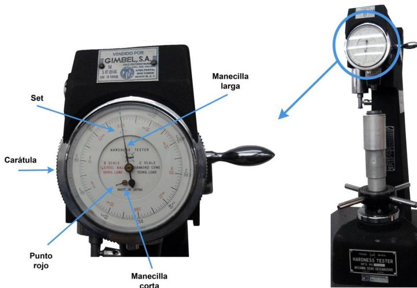
Figura 2.16. Detalle de la carátula del equipo Rockwell analógico.
