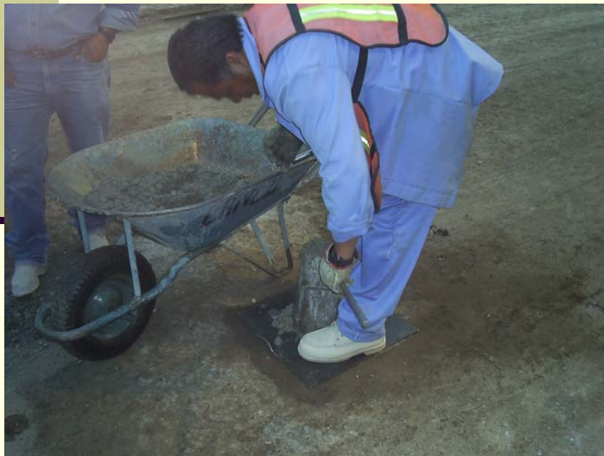
NMX-C-156-1997-ONNCCE Determinación del revenimiento en el concreto fresco.
