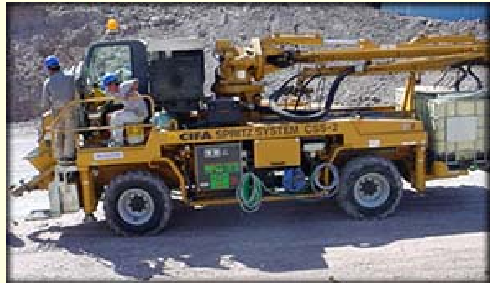
Concreto lanzado vía húmeda
