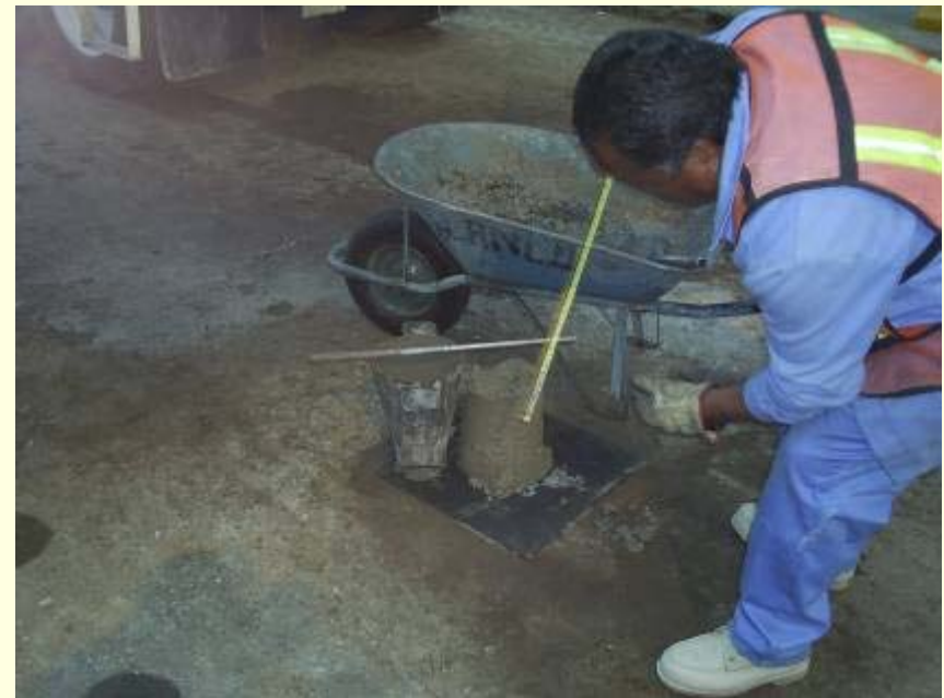
NMX-C-156-1997-ONNCCE Determinación del revenimiento en el concreto fresco.
