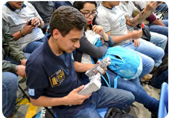
Equipos de diversas instituciones de nivel superior del país se dieron cita en el Laboratorio de Materiales para someter sus marcos a una prueba de resistencia, la cual consistió en ser impactados por una bala de aproximadamente nueve kilogramos a diferentes distancias —0.5m, 1m, 1.5m y así sucesivamente hasta llegar a los 3— al tiempo que protegen un huevo. En
