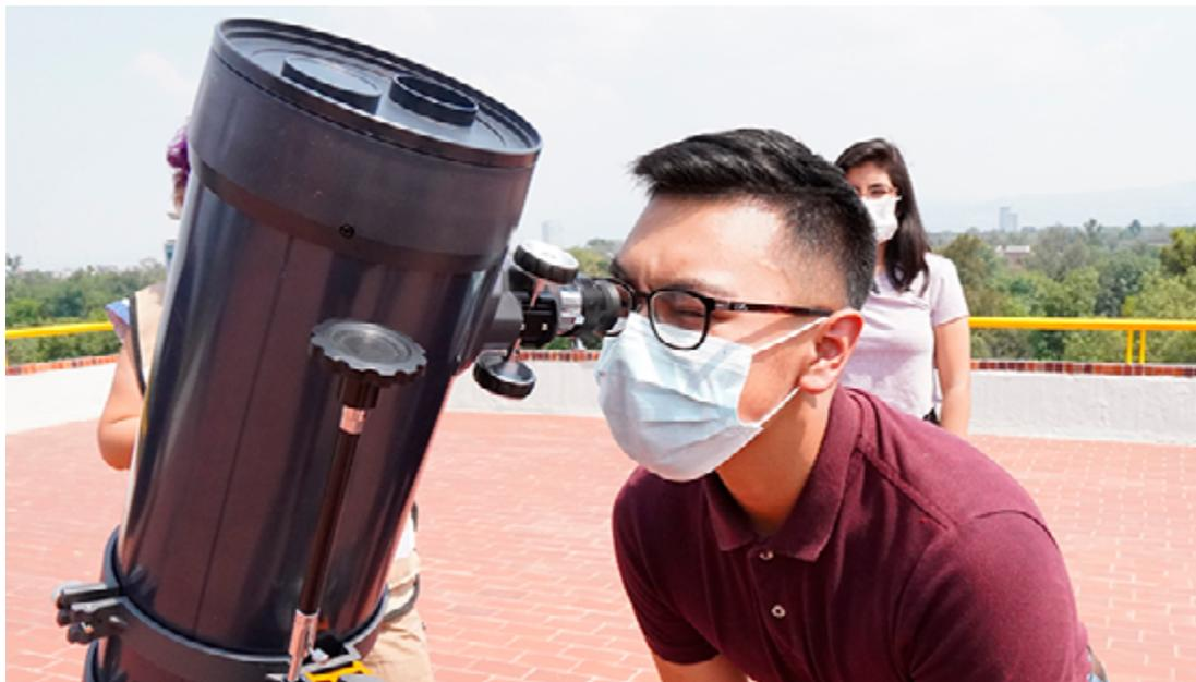
estabilidad del telescopio, se pone el freno a ambos ejes y se procede a controlar, mediante los tornillos, sus cuatro movimientos posibles: de altitud y acimut, y de ascensión recta y declinación, empleados al buscar objetos.
