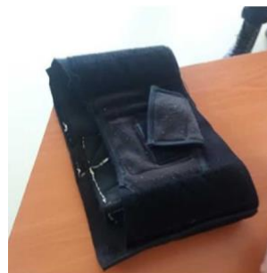
Figura 2. Faja que se coloca el sujeto de prueba con el acelerómetro
