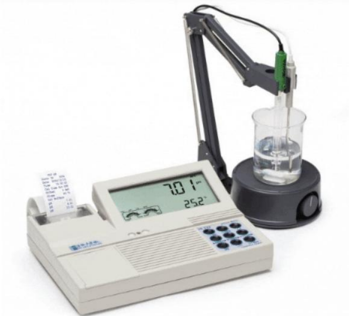
Fig. 1.3. Técnica de medición por potenciómetro de pH.
