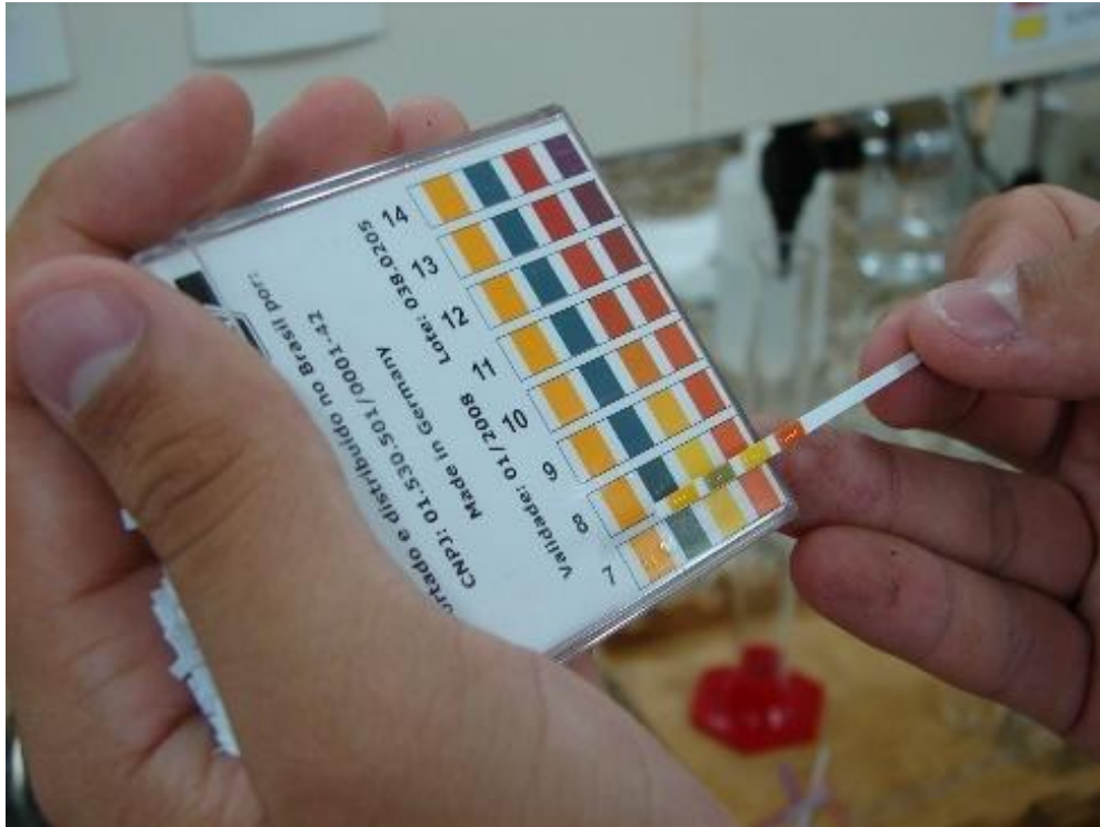
Fig. 1.2. Técnica de medición por colorimetría a través de papel tornasol.
