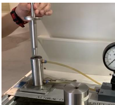
Figura 1.9. Colocación del émbolo en la cámara de la balanza de pesos muertos. Sujetar el émbolo para evitar su caída fuera de la cámara y soltar hasta que se detenga el deslizamiento.
