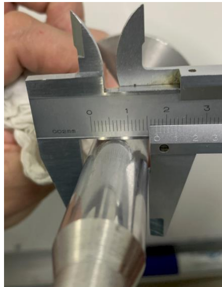
Figura 1.7. Medición del diámetro del émbolo.
