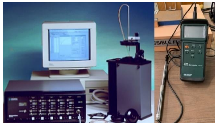
Figura 5.5. Hilo caliente para investigación (izquierda) y para mediciones de campo (derecha). Equipo del laboratorio de termofluidos.
