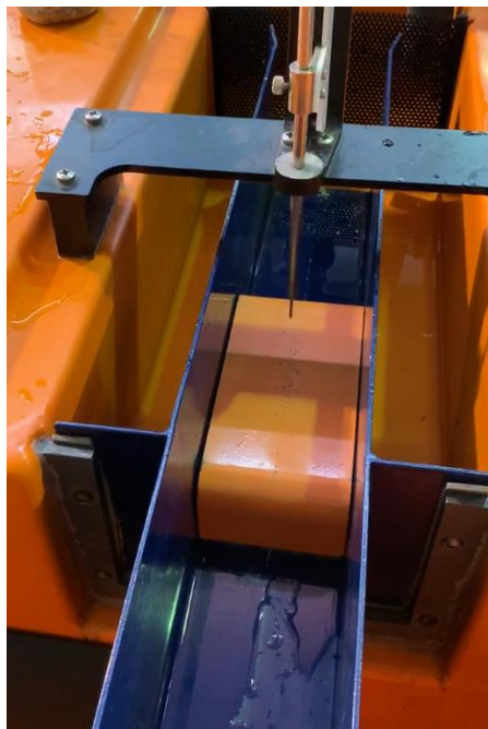
Figura 7.5. Veredero de pared gruesa y canal adicional.
