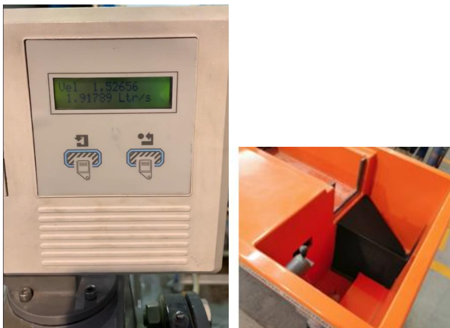
Figura 7.6. Izquierda: Medidor de flujo digital. Derecha medidor de flujo del banco de medición de gasto.
