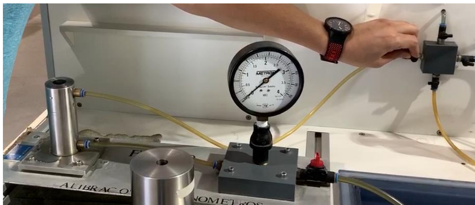
Figura 1.8. Apertura de la válvula de alimentación para llenado de la cámara con agua.
