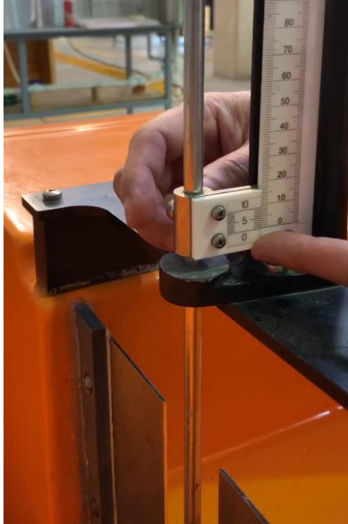
Figura 7.7. Calibración del limnómetro.
