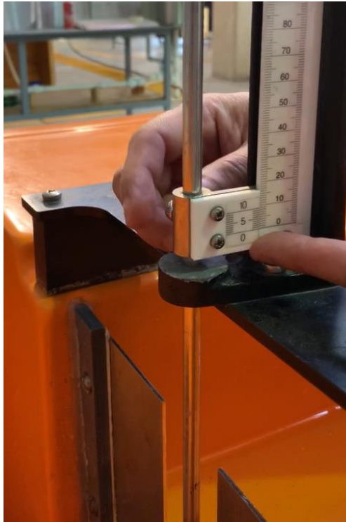
Figura 7.7. Calibración del limnómetro.
