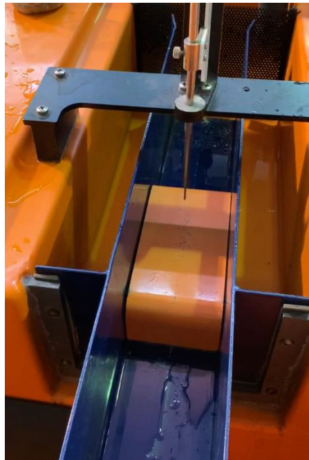
Figura 7.5. Veredero de pared gruesa y canal adicional.
