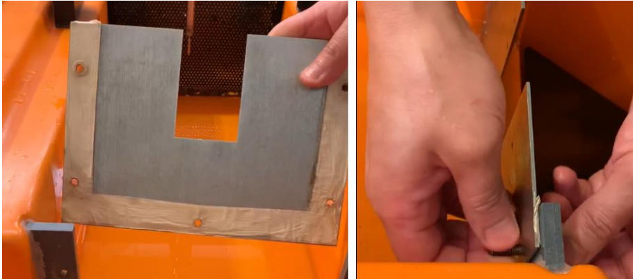
Figura 7.4. Izquierda: empaque del vertedero rectangular de pared delgada. Derecha: instalación del vertedero.
