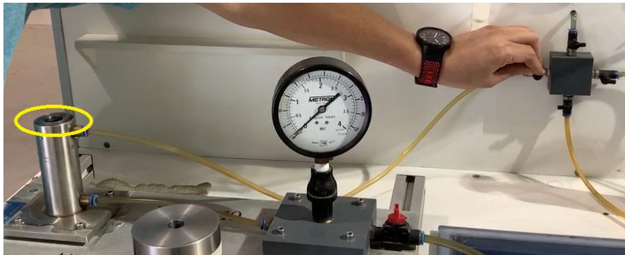
Figura 1.11. Apertura de la válvula de alimentación para rellenar nuevamente la cámara con agua.
