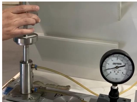
Figura 1.12. Colocación de las pesas en el émbolo.
