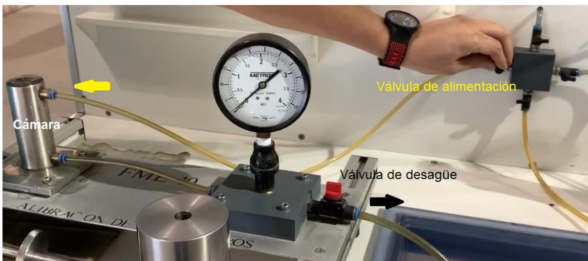
Figura 1.7. Válvula de alimentación y válvula de desagüe.
