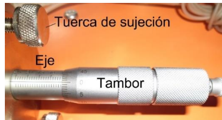
Figura 8.9. Partes del micrómetro. E.P, Alejandro Córtes E. 2018.
