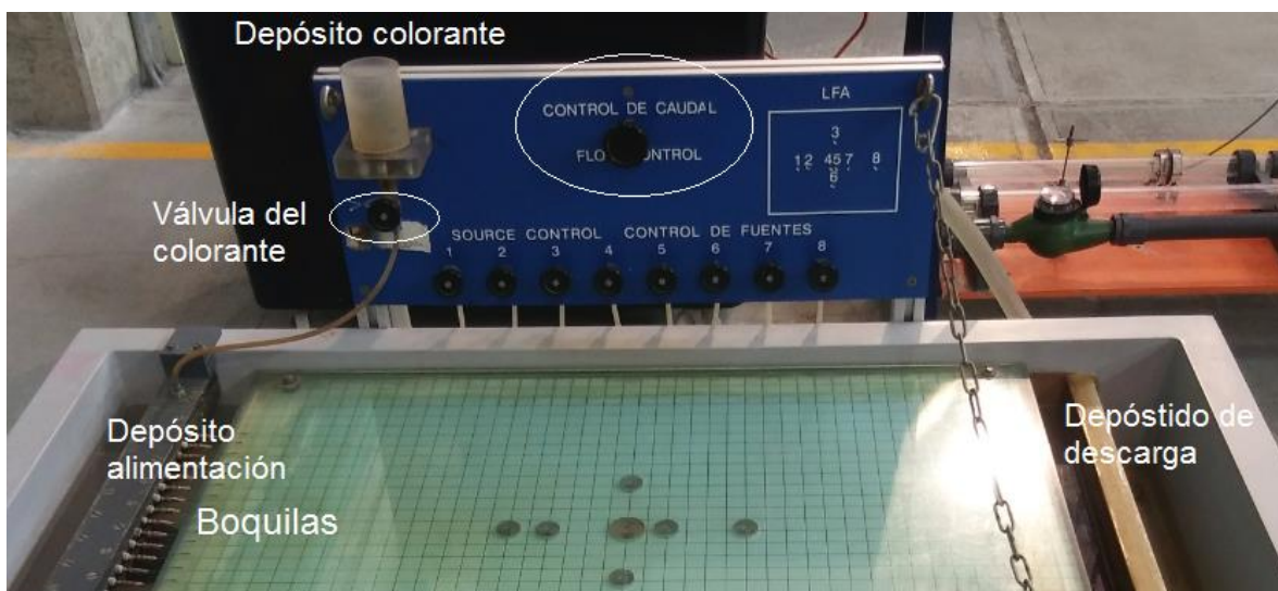
Figura 3.11. Válvula secundaria de control de caudal. EP, Alejandro Cortés E. 2020.
