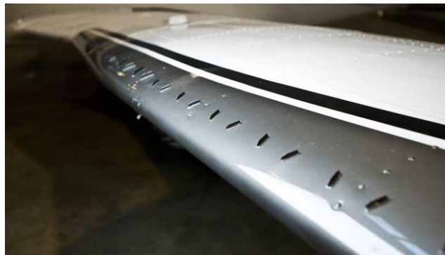
Figura 5.5. Generadores de vórtices en el ala de un avión. Recuperada de https://www.aopa.org/news-and-media/all-news/2017/august/flight-training-magazine/vortex-generators el 09/09/2020.
