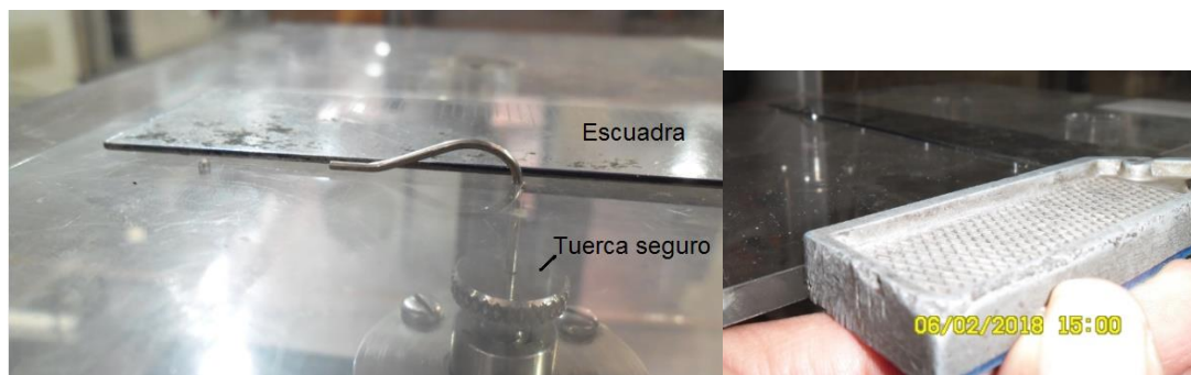
Figura 8.14. Alineación del tubo de Pitot con la corriente libre. FI UNAM. E.P, Alejandro Córtes E. 2018.
