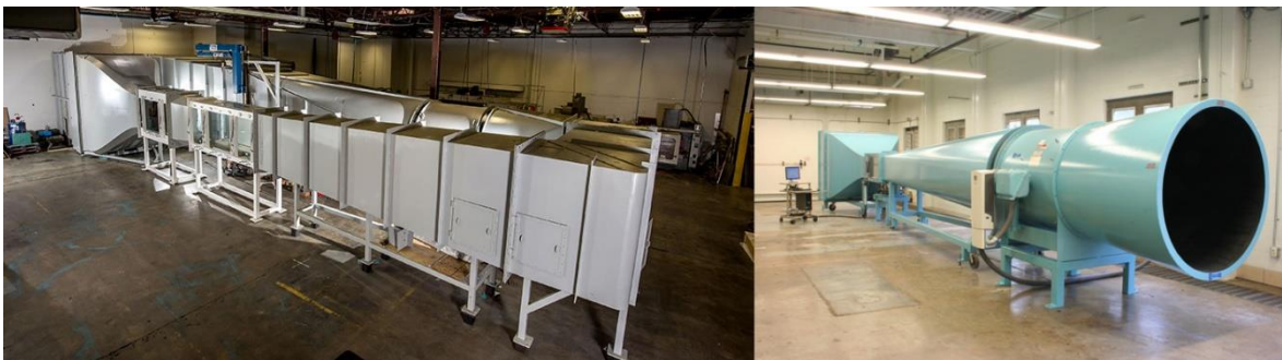
Figura 5.6. Túneles de viento de circuito cerrado (izquierda) y de circuito abierto (derecha). Recuperadas de https://www.aerolab.com/products/open-circuit-wind-tunnels/ y https://www.aerolab.com/products/closed-circuit-wind-tunnels/ el 09/09/2020.
