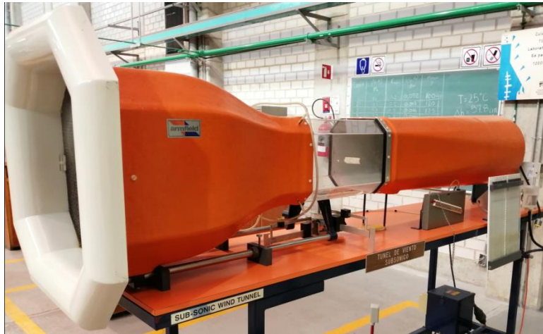
Figura 5.7. Túnel de viento del laboratorio con que se harán las pruebas.
