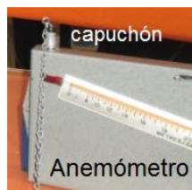
Figura 8.19. Anemómetro del túnel de viento. FI UNAM. E.P, Alejandro Córtes E. 2018.
