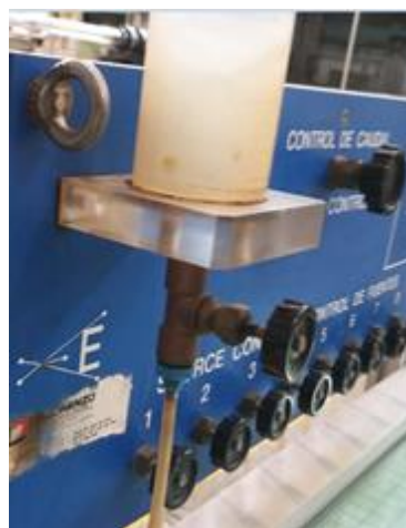
Figura 3.13. Válvula de control de caudal del colorante. EP, Alejandro Cortés E. 2020.
