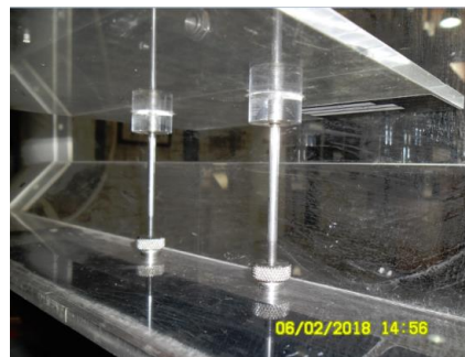
Figura 8.7. Colocación de la placa plana. FI UNAM.
