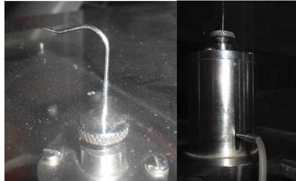
Figura 8.13. Colocación del micro tubo de Pitot en el micrómetro. FI UNAM.
