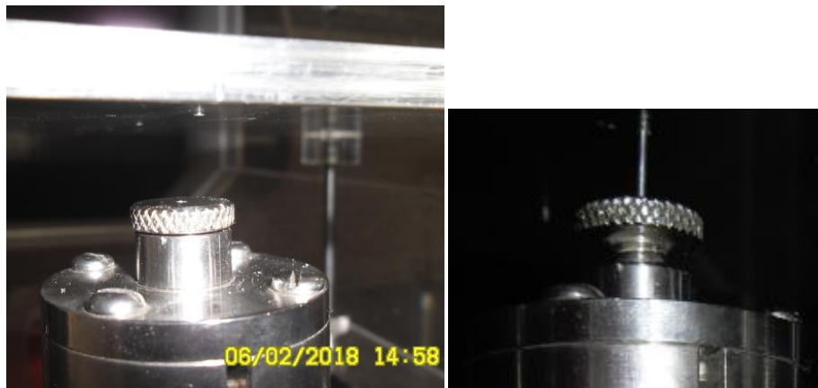
Figura 8.12. Colocación del micro tubo de Pitot en el micrómetro. FI UNAM.
