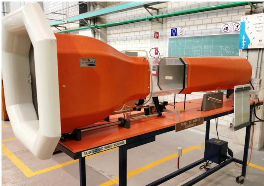
Figura 8.3. Túnel de viento subsónico del Laboratorio de Termofluidos, FI UNAM.
