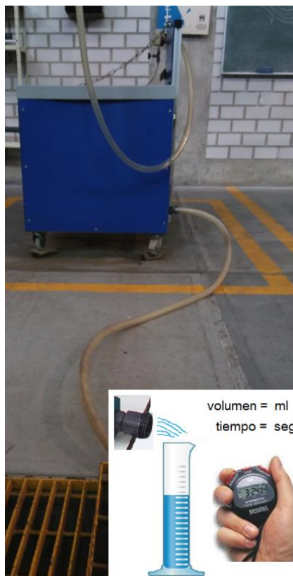
Figura 3.17. Medición del gasto volumétrico. EP, Alejandro Cortés E. 2020.
