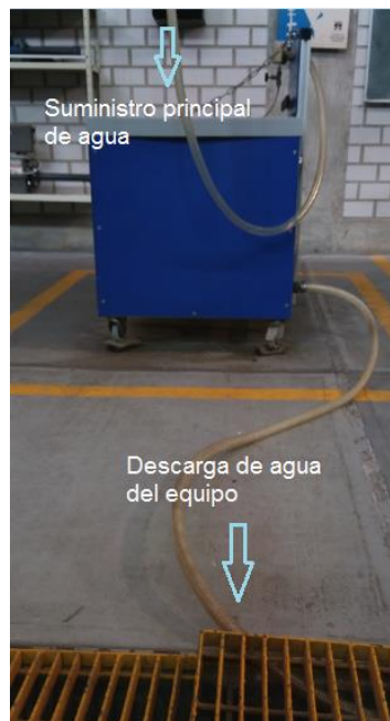
Figura 3.9. Descarga de agua del equipo Hele-Shaw. EP, Alejandro Cortés E. 2020.
