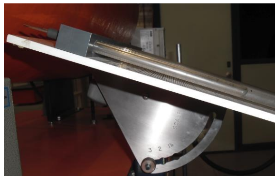
Figura 8.17. Inclinación del banco de manómetros. FI UNAM.
