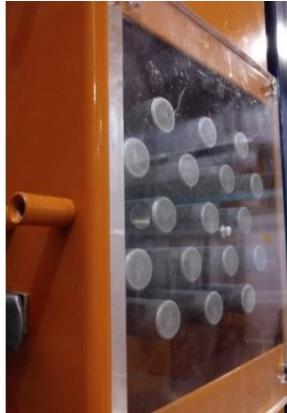
Figura 6.6. Detalle de la separación (4 mm) entre el extremo de las aletas y la placa de acrílico del dispositivo experimental.
