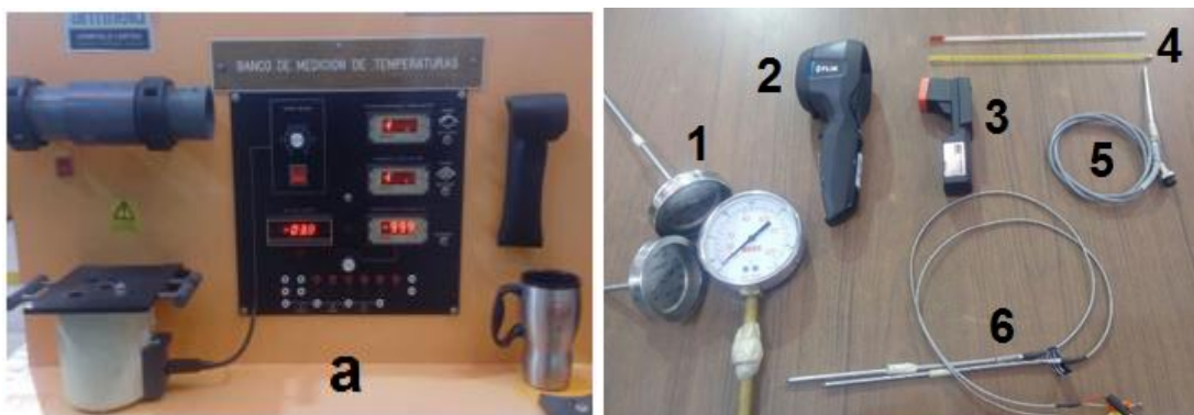
Figura 1.3. a) Unidad de demostración de medición de temperatura, b) 1. Bimetalico, 2. Cámara termográfica, 3. Pirómetro, 4. Termómetro de mercurio y de alcohol, 5. Resistencia de platino, 6. Termopares tipo K y J.
