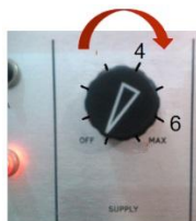
Figura 5.7. Control de la velocidad del ventilador.
