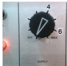
Figura 7.8. Control de la velocidad del ventilador.
