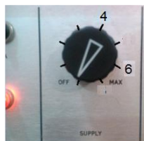
Figura 6.14. Control de la velocidad del ventilador.
