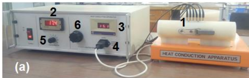
Figura 2.2 a) equipo Armfield: 1. Termistores, 2. Indicador de temperatura [\text{ }^\circ\text{C}] , 3. Indicador de potencia suministrada [\text{W}] , 4. Power, 5. Perilla para seleccionar termistor, 6. Perilla para cambiar la potencia.
