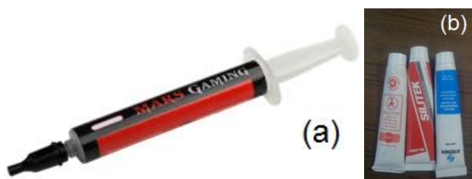
Figura 2.1 a) Las pastas térmicas que se utiliza en el laboratorio, conductividad térmica entre 0.5 a 0.7 \text{ [W/m}\cdot\text{K]} , precio por gramo aproximado de 2.28 pesos/ gramo, b) pasta térmica de alto diseño, conductividad térmica de 9 \text{ [W/ m}\cdot\text{K]} , precio por gramo aproximado de 54.82 pesos/ gramo. Precios del año 2017.
