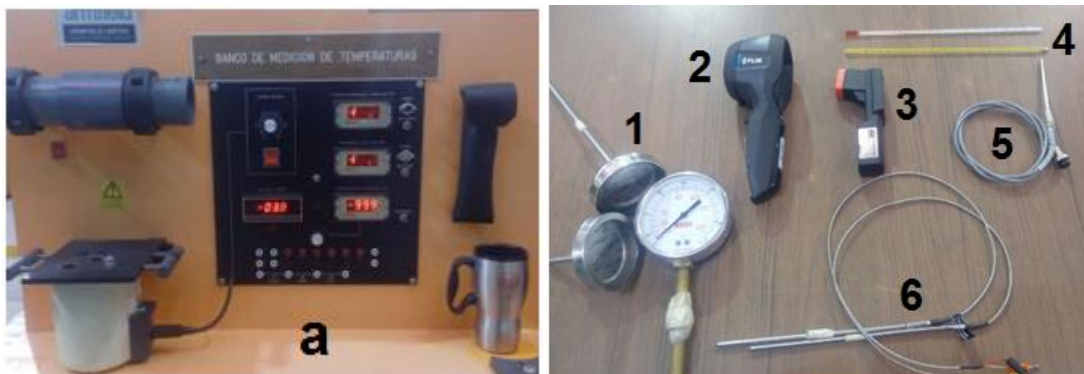
Figura 1.3. a) Unidad de demostración de medición de temperatura, b) 1. Bimetálico, 2. Cámara termográfica, 3. Pirómetro, 4. Termómetro de mercurio y de alcohol, 5. Resistencia de platino, 6. Termopares tipo K y J.
