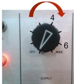
Figura 6.6. Control de la velocidad del ventilador.
