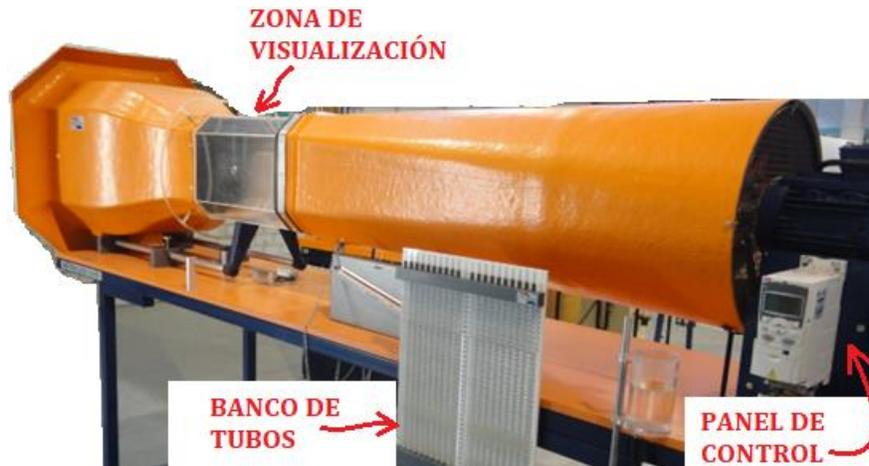
Figura 2.8. Túnel de viento del laboratorio.
