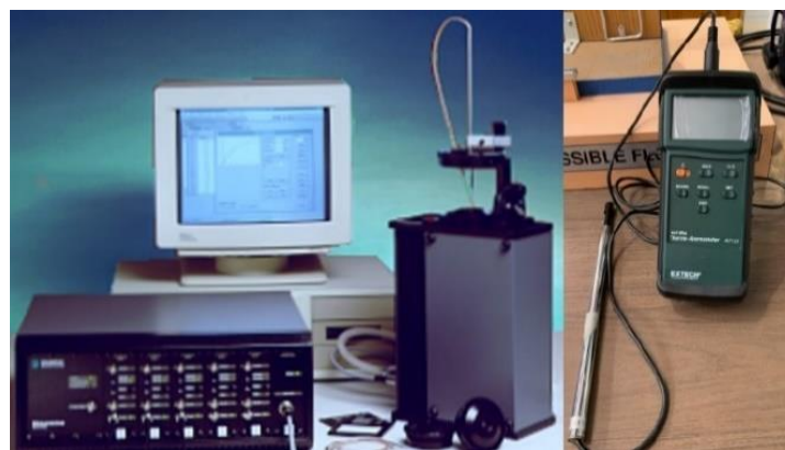
Figura 2.5. Hilo caliente para investigación (izquierda) y para mediciones de campo (derecha). Equipo del laboratorio de termofluidos.
