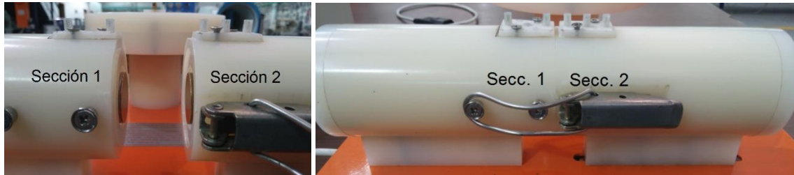
Figura 5.4. Arreglo experimental. Conducción de calor en un cilindro de latón.
