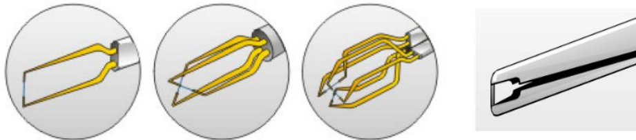
Figura 2.4. Probetas para flujos unidimensionales, bidimensionales y tridimensionales y anemómetro de película caliente. Dantec Dynamics (2001) [Diapositiva de Power Point]. Dantec Dynamics. https://www.dantecdynamics.com .
