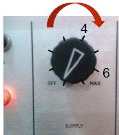
Figura 6.6. Control de la velocidad del ventilador.
