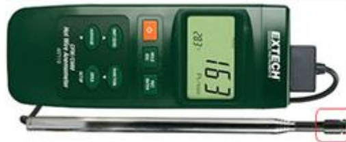
Figura 6.5. Anemómetro de hilo caliente, indicando la protección de los sensores de velocidad y temperatura.
