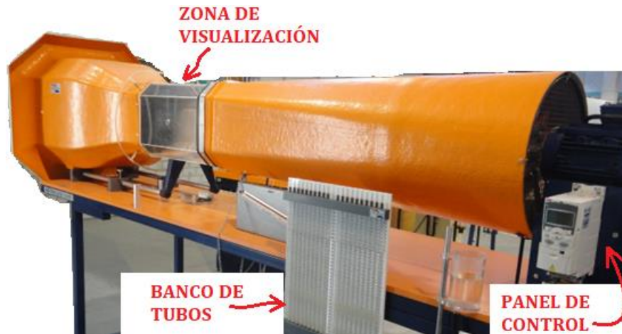
Figura 2.8. Túnel de viento del laboratorio.
