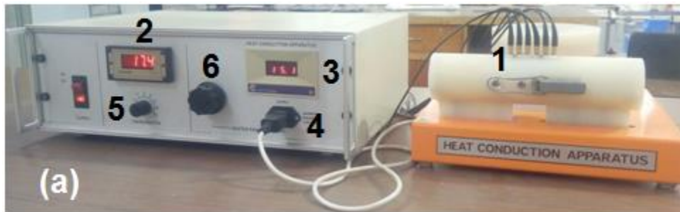
Figura 5.2 a) equipo Armfield: 1. Termistores, 2. Indicador de temperatura [ ^\circ\text{C} ], 3. Indicador de potencia suministrada [ \text{W} ], 4. Power, 5. Perilla para seleccionar termistor, 6. Perilla para cambiar la potencia.
