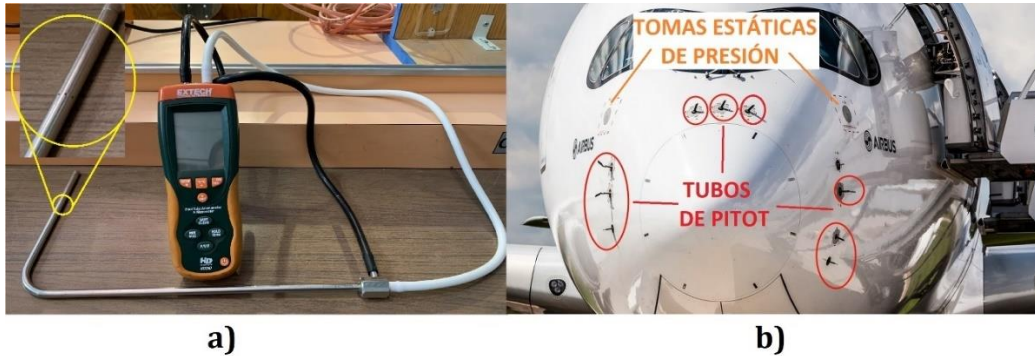
Figura 2.2. a) Tubo Pitot estático o Prandtl. b) Tubo de Pitot y tomas estáticas de presión independientes.
