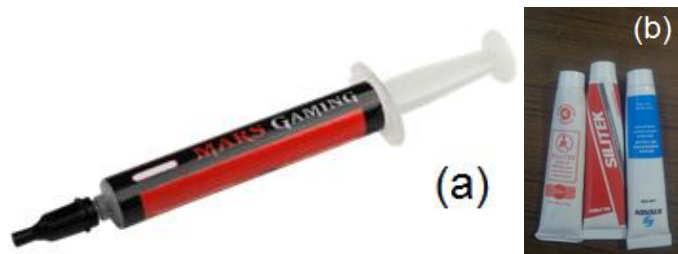
Figura 5.1 a) Las pastas térmicas que se utiliza en el laboratorio, conductividad térmica entre 0.5 a 0.7 \text{ [W/m}\cdot\text{K]} , precio por gramo aproximado de 2.28 pesos/ gramo, b) pasta térmica de alto diseño, conductividad térmica de 9 \text{ [W/ m}\cdot\text{K]} , precio por gramo aproximado de 54.82 pesos/ gramo. Precios del año 2017.
