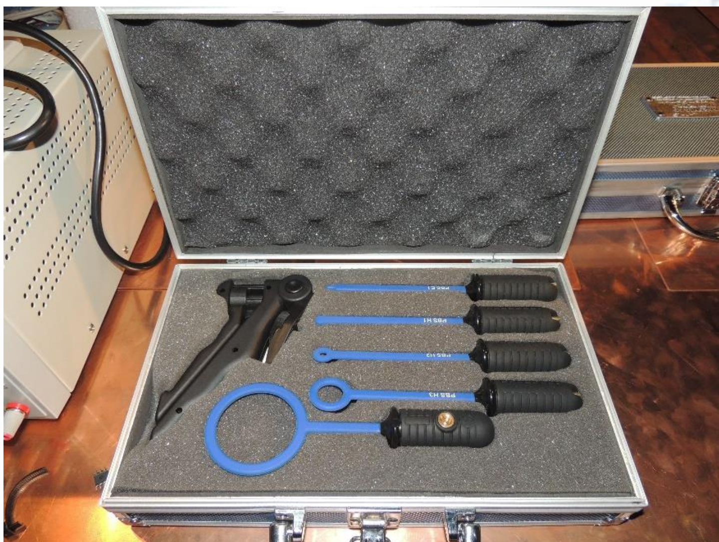
MEDIMOS LOS CAMPOS, ELÉCTRICO Y MAGNÉTICO, CON SONDAS DE CAMPO CERCANO
